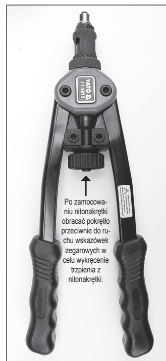
Właściwie przygotowana nitownica do montażu nitonakrętki.
